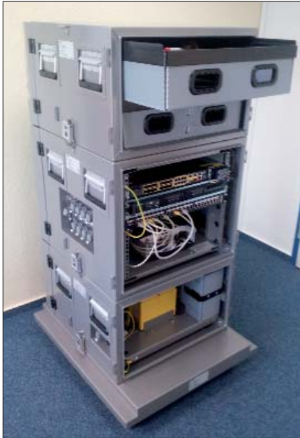
Bild 4: Transport-, MBS- und MBS-USV-Modul (ohne Abdeckungen)
