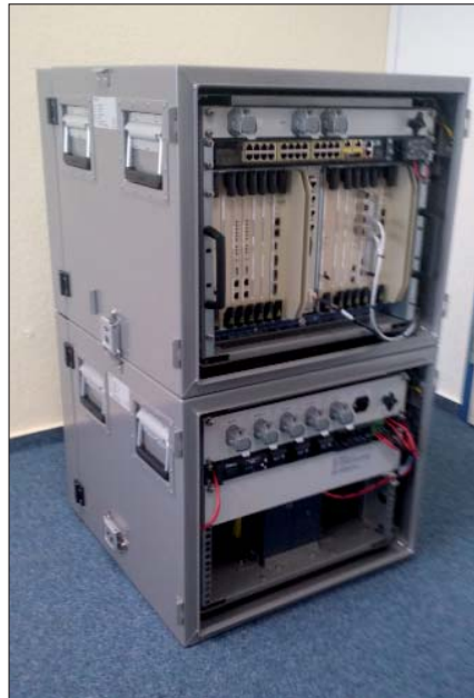
Bild 5: DXT-Modul und DXT-USV-Modul (ohne Abdeckungen)
