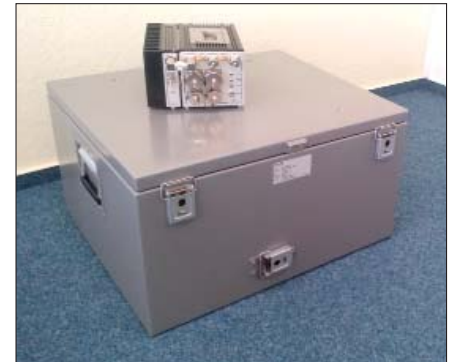
Bild 6: Systemmodul zur Vernetzung bzw. Anbindung der MBS (auf einem Transportmodul)
